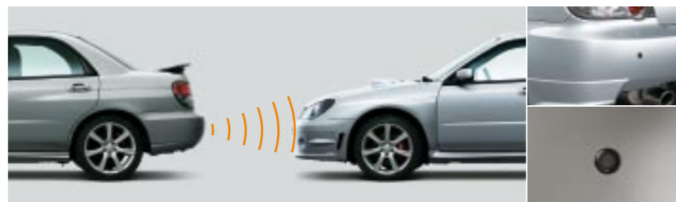
95 Ultrasonic Parkeringshjælp (For, Bag) SEWAYA2100, SEWAYA2000 E For: Sikker og nem parkering ved brug af 2 sensorer. Aktiveres med blinklyskontakten. Akustisk advarsel. Bag: sikker og nem parkering ved brug af 4 sensorer. Akustisk og visuel advarsel.
