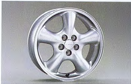
21 Aluminiumsfælg 5-egret (16") 28111FC130 W 16x6.5JJ offset 48 215/60R16
