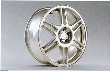
15 Aluminiumsfælg, sølv (17") SESLSA4000 E 17x7JJ offset 48 215/55R17
