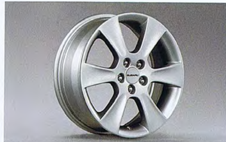
22 Aluminiumsfælg 6-egret (16") SECWAG4000 E 16x6.5JJ offset 48 215/60R16
