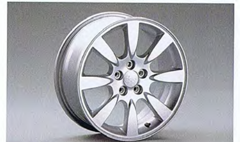
23 Aluminiumsfælg 8-egret (16") 28111SA090 W 16x6.5JJ offset 48 215/60R16
