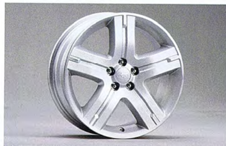
16 Aluminiumsfælg 5-egret (17") 28111SA190 W 17x7JJ offset 48 215/55R17
