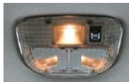
41 Læselamper til bagsæde H461SXA000 W Individuelt læselys til højre og venstre side i 2.sæderække med separat tænd/sluk.
