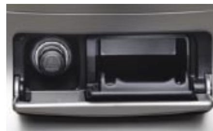
72 Rygerkit H6010SA000 W Forandrer tilbehørs soklen til cigaretligter, og kommer sammen med et askebæger.
