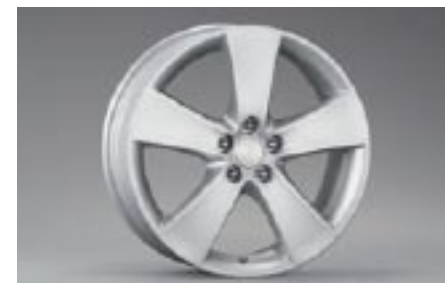
18 Aluminiumfælg (17") SECWAG4100 E 17x7JJ offset 48 215/55R17
