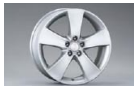
22 Aluminiumsfælg 5-egret (17") SECWFE4100 E 17x7JJ offset 55 215/45R17
