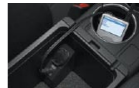
72 AUX jack H6210AG000 W Et 3,2 mm jack stik som tillader dig at tilslutte din MP3 afspiller (eller lign) til anlægget, og høre det gennem bilens højttalere.
