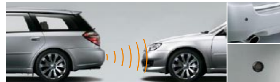
75 Ultrasonic Parkeringshjælp (For, Bag) SEWAYA2100, SEWAYA2000 E For: Sikker og nem parkering ved hjælp af 2 sensorer. Bliver aktiveret af parkeringslys knappen. Akustisk alarm Bag: Sikker og nem parkering ved hjælp af 4 sensorer. Akustisk og visuel alarm
